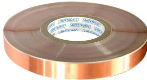
Le ruban de cuivre plat Ampetronic est le choix par défaut lors de l'installation d'un câble en boucle sous des revêtements de sol tels que tapis, bois, stratifié, carrelage ou linoléum. Le câble ne sera pas visible sous la plupart des revêtements de sol et est généralement fixé au sol avec du ruban d'avertissement imprimé qui avertit les artisans, tels que les ajusteurs de tapis, de sa présence.
